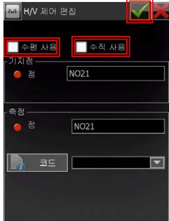
3. 다른 점들의 수평잔차와 수직잔차가 줄어드는 것을 알 수 있습니다. 여기서 잔차의 값은 작으면 작을수록 좋은데 0이 될 필요는 없습니다. 보통 RTK의 기기 정밀도가 수평의 경우 1cm + 1ppm, 수직의 경우 2cm + 1ppm 이므로 사용자의 판단에 따라 적용하면 됩니다. 만족스러우면 홈버튼을 클릭합니다.
